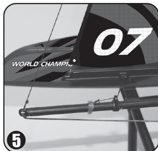
6. Fädeln Sie die Fockauslegerleine durch die Öse (von der Vorderseite zur Rückseite) im Mittelholm, fädeln Sie sie durch die Deck Öse am vorderen Querträger und befestigen Sie die Kordelschleife an der Klammer.
